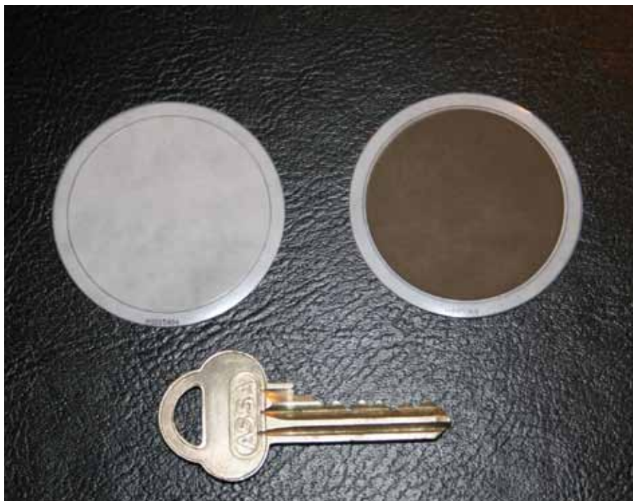
Mynd 2. Svifrykssíur frá Akureyri. Hvíta sían er ónotuð en í gegnum brúna síuna var dregið jafnmikið loftmagn og meðalmaður andar að sér á einum sólarhring. Mynd ÞJ
